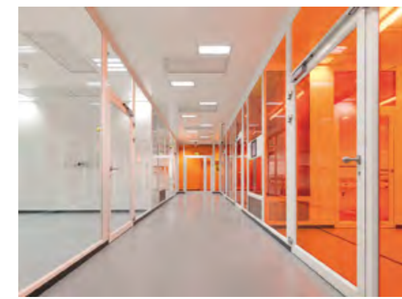
Die Labore selbst sind offen und kompakt konzipiert. Sie sind umgeben von einem Grauraum, der nur über Schleusen zugänglich ist.
