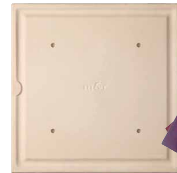
Obwohl die Kacheln geringe Abmessungen aufweisen, wurden trotzdem vier Befestigungen pro Platte ausgeführt (links eine Abbildung der Rückseite), um ein Klappern der Fassade bei Windbeanspruchung zu vermeiden. Obwohl die Kacheln geringe Abmessungen aufweisen, wurden trotzdem vier Befestigungen pro Platte ausgeführt (links eine Abbildung der Rückseite), um ein Klappern der Fassade bei Windbeanspruchung zu vermeiden.
