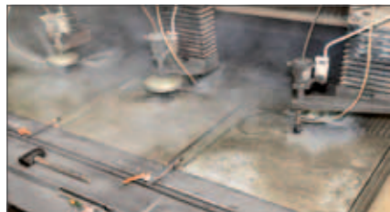
Drei Hochdruck-Schneidköpfe im Parallelschritt bei einem Druck von rund 3500 bar. Das Ergebnis: Exakte geschnittene Polygone aus Feinsteinzeug für ein Agrob-Buchtal-Projekt in der Schweiz
