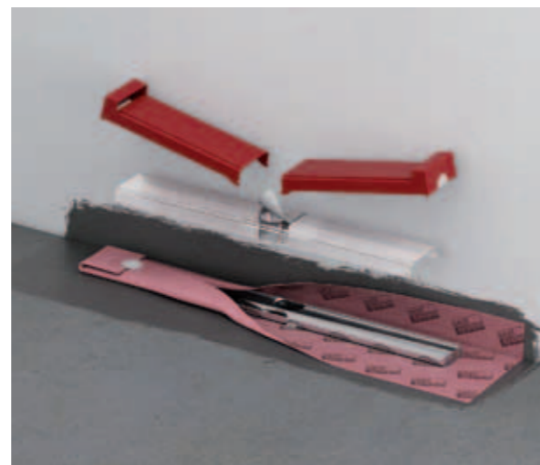
Die neue TECEdrainline-Evo mit Bauzeitenschutz und werkseitig angebrachter Dichtmanschette. Es bleibt bei der bewährten Edelstahlrinne mit Kapillarschutzkante.
