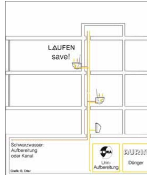
Der Querschnitt zeigt, wie der Urin mittels des Trenn-WCs save! separiert werden und schon im Gebäude nach dem Vuna-Verfahren zu Dünger aufbereitet werden kann. © Vuna GmbH
