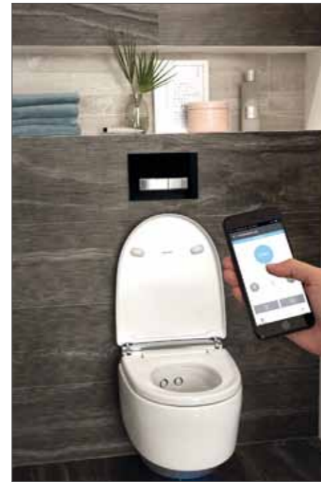
Ein Dusch-WC ermöglicht körperlich eingeschränkten Menschen mehr Freiheit beim Toilettengang: Eine Fernbedienung oder App steuert den Duscharm, die Stärke des Duschstrahls und Föhns sowie die Ladydusche. (Foto: Geberit)
