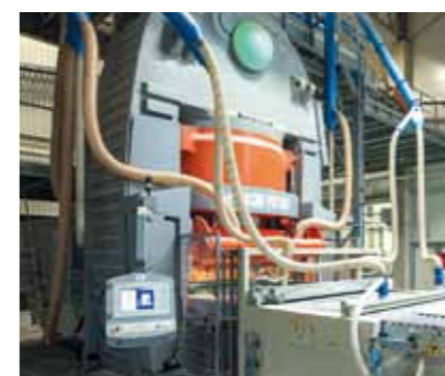
Finger weg! Einem Pressdruck von 7500 bzw. 6500 Tonnen („made in Italy“) hält nur die getrocknete Fliesenmasse stand.
