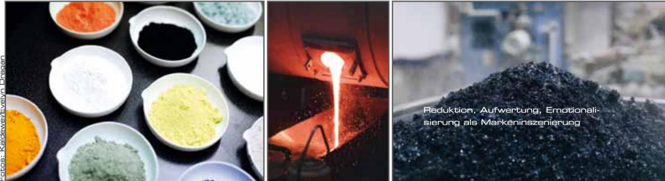
Von links: Die Rohstoffe für die Emailherstellung stammen aus sechs Kontinenten. Abstich in der Kaldewei Emailschmelze: Dabei wird eine glühend heiße Glasschmelze in kaltem Wasser abgeschreckt. Die Emailfritte, ein Glasgranulat, wird anschließend in der Mühle zu spritzfähigem Emailschlacker verarbeitet.
