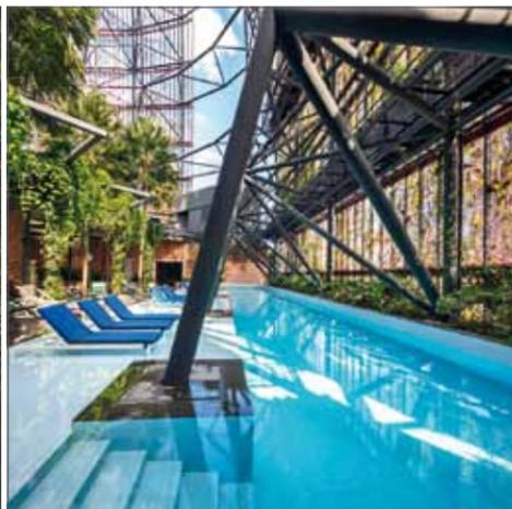
Die Top-Roof-Pools auf der obersten 27. Etage beinhalten 0,15 Meter flache „Watbecken“ mit Ruheliegen. Von dort führen Treppen in den 1,20 Meter tiefen Pool. Umgeben wird die gesamte Dachfläche von einem mehrere Stockwerke hohen semitransparenten Schirm aus dem gleichen roten Aluminiumgewebe wie der Rest des Gebäudes.
