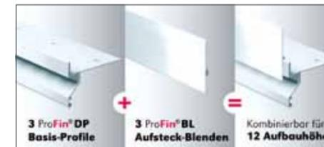
kombiniert werden. Insgesamt lassen sich so zwölf unterschiedliche Aufbauhöhen zwischen 11 und 90 mm umsetzen. Ungestanzte Schenkel und selbstklebende Systemdichtbänder sorgen dafür, dass Abdichtungen sicher an die Profile angeschlossen werden können. Zusätzlich können die Profile in eine Balkonrinne für regelgerechte Randentwässerung eingehängt werden.
