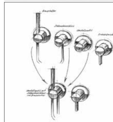
Aus drei macht eins: Die Skizze links zeigt, wie die Armatur für eine übersichtliche Optik der Installation sorgt, zum Beispiel wie auf dem Bild oben links mit Wanneneinlauf, Umstellventil mit Schlauchanschluss und Brausehalter sowie dem Einhebelmischer. Möglich sind runde oder eckige Rosetten. Rechts oben ein Blick hinter die Kulissen: Eine spezielle Montageschiene gewährleistet die exakte Ausrichtung der einzelnen Elemente.
