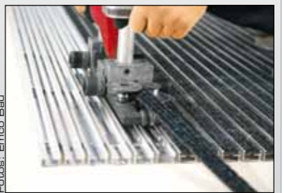
Für die tagesaktuelle Säuberung kann die Matte aufgerollt und der Schmutz aufgefegt oder aufgesaugt werden. Wenn nach Jahren des Gebrauchs die Einlagen beschädigt oder verschlissen sind, können sie mit einer Ripswechselmaschine ausgetauscht werden. (Fotos: Emco)
