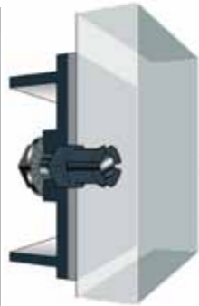
Links: Eine Besonderheit der Fassade ist die Hinterschnitt-Verankerung, für die es eine europäische technische Zulassung sea DIBt gibt
